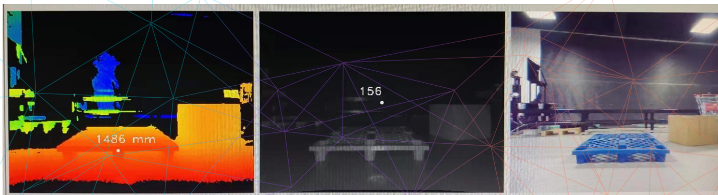
DCAM560C同时捕捉深度图，IR图及彩色图
